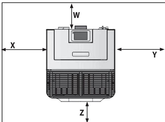
Neben den reinen Sicherheitsmindestabständen muss die Möglichkeit gegeben sein, dass normale Reinigungs- bzw. Wartungsarbeiten ausgeführt werden können. Es sind daher folgende Mindestabstände für Wartungs- und Reinigungsarbeiten einzuhalten:
