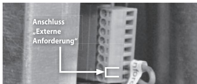
Es wird die **Steuerelektronik** sichtbar. Der Anschluss erfolgt an die entsprechende Klemmenleiste.
