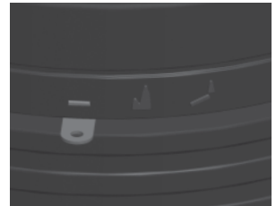
Abb. 4.9 Verbrennungsluftschieber: ganz links - ganz geschlossen
