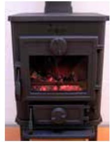
6. 3 Stück Holzscheite à ca. 0,8 kg bzw. 30 cm Länge in einer Schicht und unter Einhaltung von ca. 1 cm großen Abständen auf der Glut verteilen.
