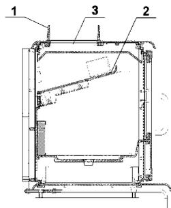
**Achtung: Die Reinigungsklappe (2) soll während der Heizung immer korrekt plaziert sein, sonst wird die Temperatur bei der Topplatte zu hoch und kann dauerhafte Beschädigungen verursachen.**
