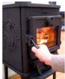
5. Neues Brennholz wird normalerweise nachgelegt, solange sich noch Glut im Ofen befindet. Verteilen Sie dazu die Glut auf dem Boden und achten Sie darauf, dass die meiste Glut vorne liegt.
