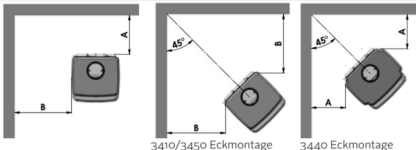
Mit Rücksicht auf Wärmezirkulation, Reinigung und evtl. Säuberung des Ofens von innen, sollte der Abstand zum Mauerwerk 10-15 cm betragen. Eine Schicht Tapete wird normalerweise, wenn sie auf Mauerwerk angebracht ist, nicht als brennbares Material angesehen.
