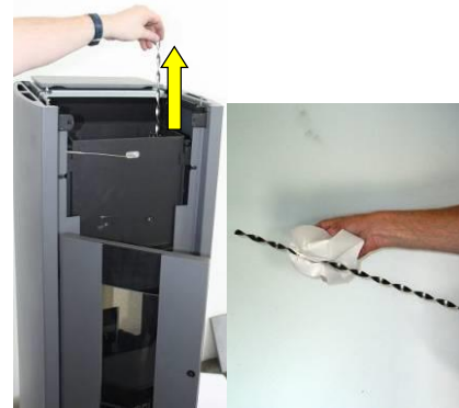
Abb. 82: Entnahme und Reinigung Turbulator
