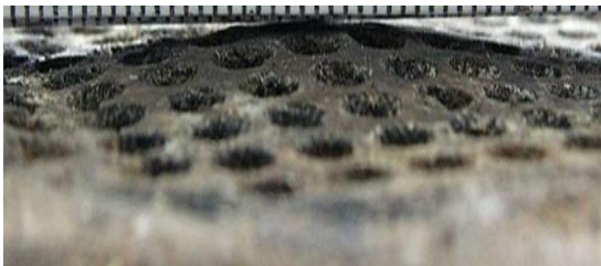
Abb. 74: Rost mit Wölbung / Verzug
