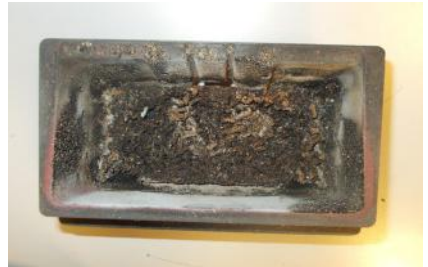
BEISPIEL VERSCHMUTZTE BRENNSCHALE
