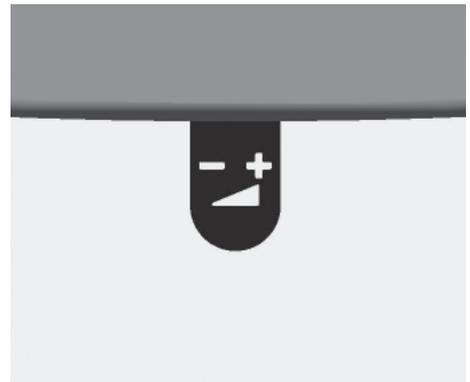
Abb. 4.4 Markierung auf dem Verbrennungsluft-Hebel
