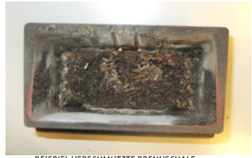
BEISPIEL VERSCHMUTZTE BRENNSCHALE
