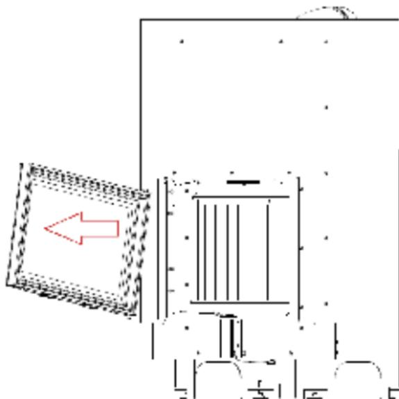
Das Verfahren für die Demontage und den Austausch der Schallwand und des Accumote -
