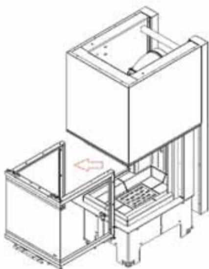
Das Verfahren für die Demontage und den Austausch der Schallwand und des Accumote -
