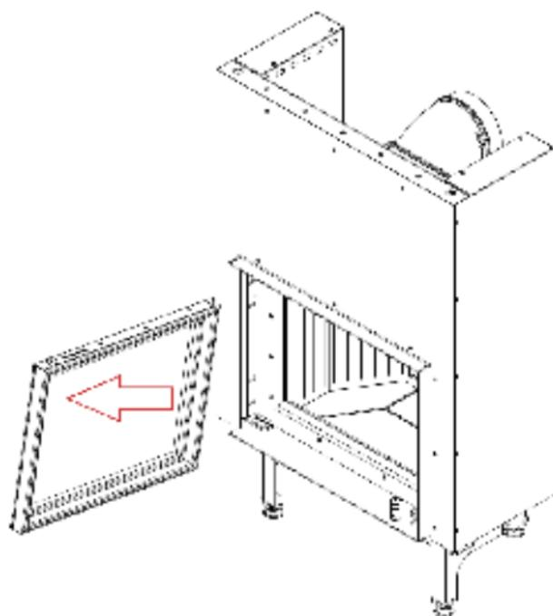
Das Verfahren für die Demontage und den Austausch der Schallwand und des Accumote - die **Serie FRAM 1**.
