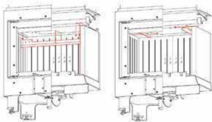
Die Reihenfolge der Entfernung von Accumote-Komponenten
