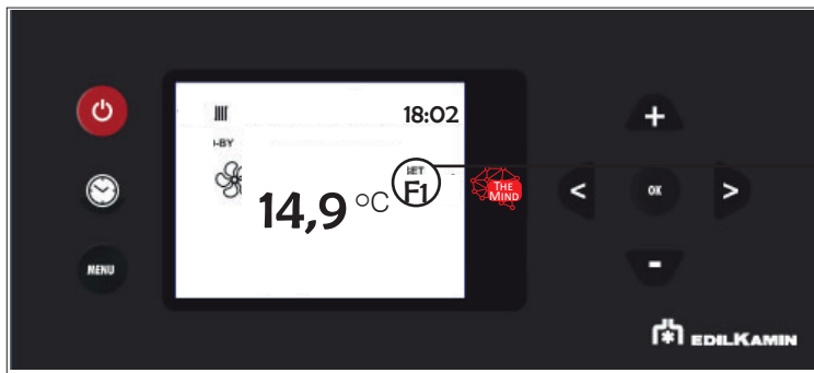
Anzeige der Nummer des Ventilators
