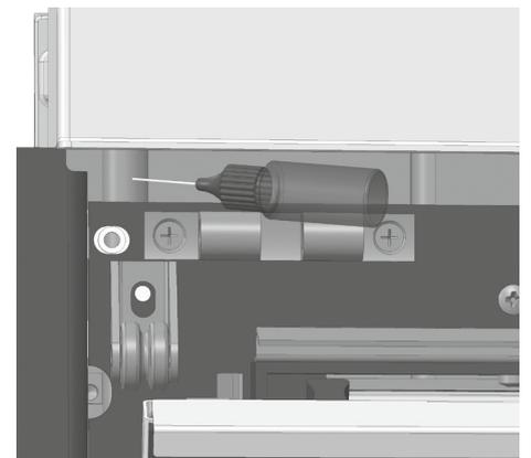
Abb. 2: Ölen der Führungsstange im oberen Bereich
