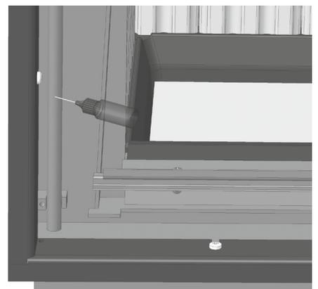
Abb. 3: Ölen der Führungsstange im unteren Bereich
