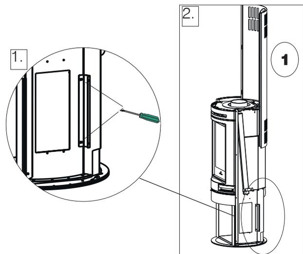
3a. Das Bauteil mit 2 Schrauben im oberen Abschnitt befestigen.
