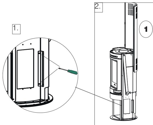
3. Das Bauteil mit 2 Schrauben im oberen Abschnitt und mit 4 Schrauben (je 2 Stck. pro Seite) im unteren Abschnitt befestigen.
