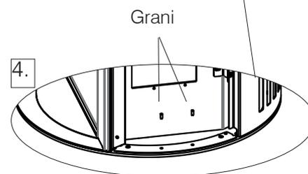
5. Die Seitenteile (2) anbringen und oben an jeder Seite mit 2 Schrauben befestigen. Darauf achten, dass der untere Abschnitt korrekt auf die zuvor eingeschraubten Stiftschrauben aufgesetzt ist.
