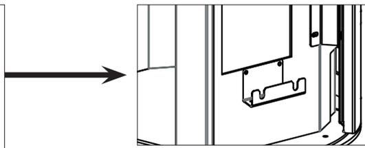
Das untere Seitenteil aus Naturstein an der Metallhalterung einfügen. Die Stifte in die Bohrungen der Halterung einrasten.
