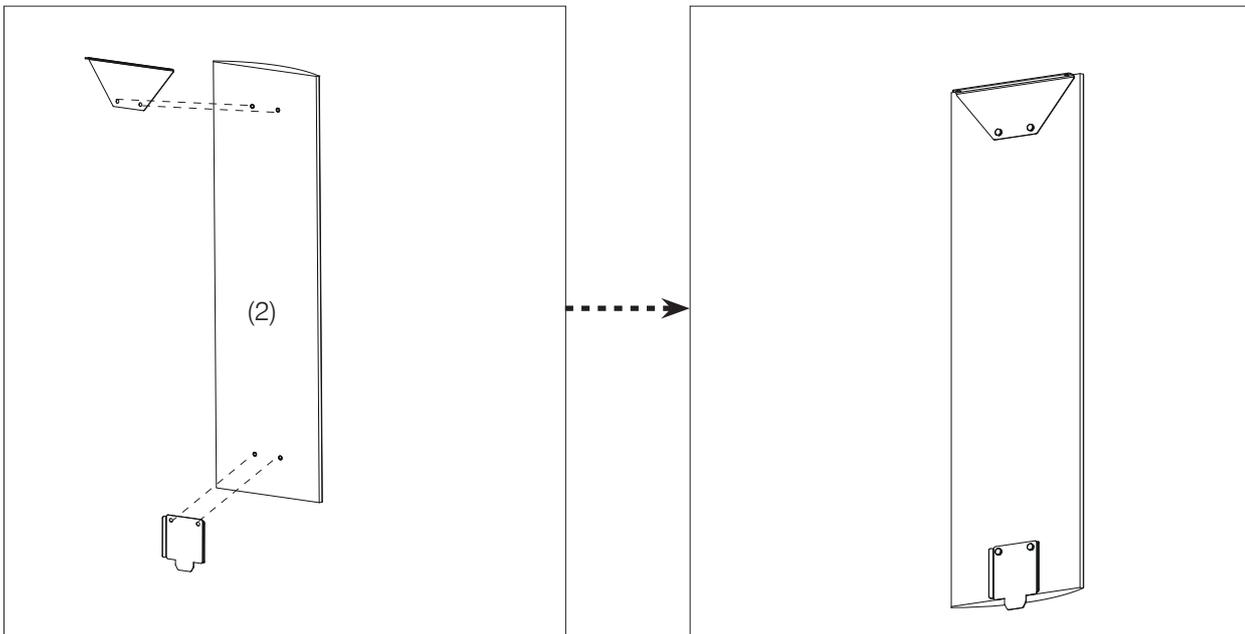
Das obere Seitenteil auf das untere Seitenteil positionieren.
