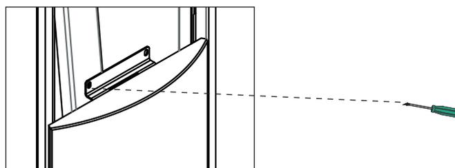
Die zwei Teile der oberen Frontblende aus Naturstein zusammenfügen (groß in der Version S und klein in der Version F); dazu die Natursteinelemente an das Frontblech aus Teilesatz S anschrauben.
