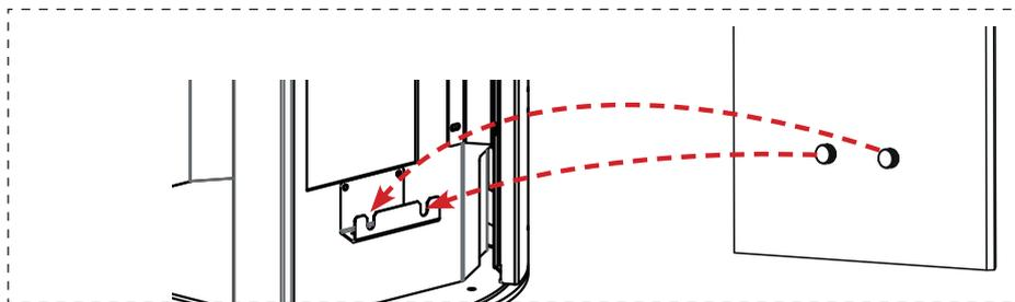
Das untere Seitenteil an der Struktur anschrauben (mit nur einer Schraube, siehe nachstehende Abbildung).
