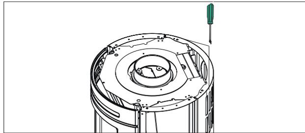
Die Rückwand mit 4 Schrauben (je 2 Stck. pro Seite) oben an der montierten Halterung aus Teilesatz S anschrauben.
