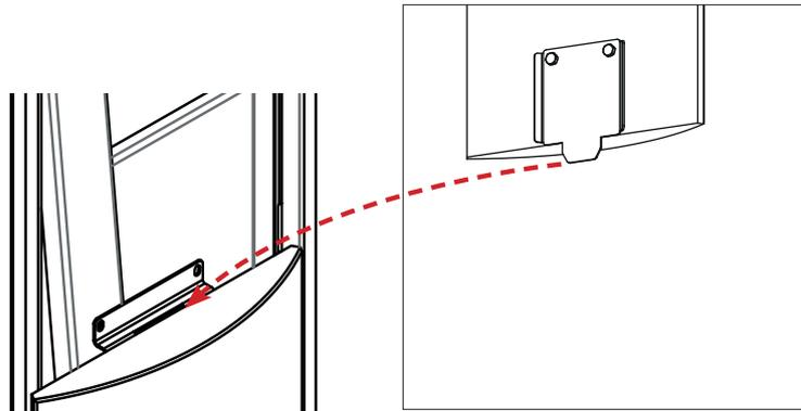
Die Schrauben der oberen Halterung an der Struktur einschrauben.
