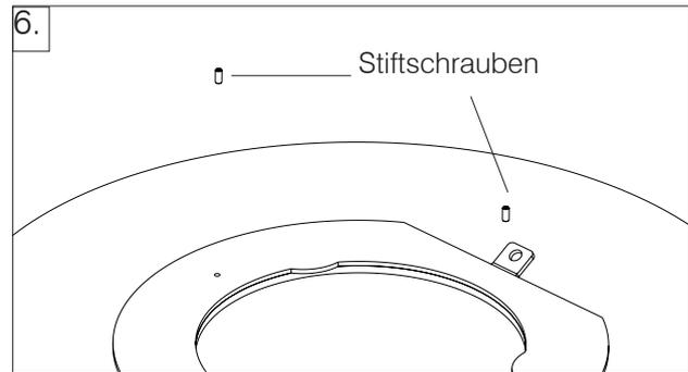
7. Dann die Abdeckplatte auflegen und die Stiftschrauben in die Bohrungen des U-förmigen Blechs einsetzen; eventuelle Justierungen mit Schraube A vornehmen.
