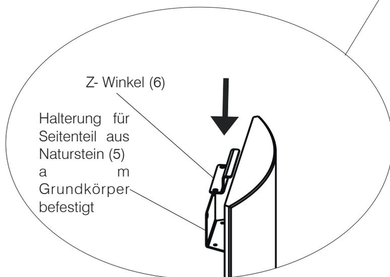
8. Die Abdeckplatte auflegen und die Befestigungsstifte in die Bohrungen des U-förmigen Blechs einsetzen.
