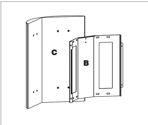
2. Das obere Frontblech vom Grundkörper abnehmen, dazu die seitlichen Schrauben herauschrauben.
