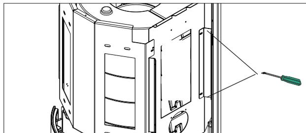
Die Rückwand mit 4 Schrauben (je 2 Stck. pro Seite) unten an der Halterung aus Punkt 1 anschrauben.
