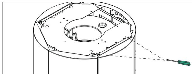
Das Oberteil auflegen und die Befestigungsstifte zentriert in die Bohrungen des U-förmigen Blechs einsetzen.
