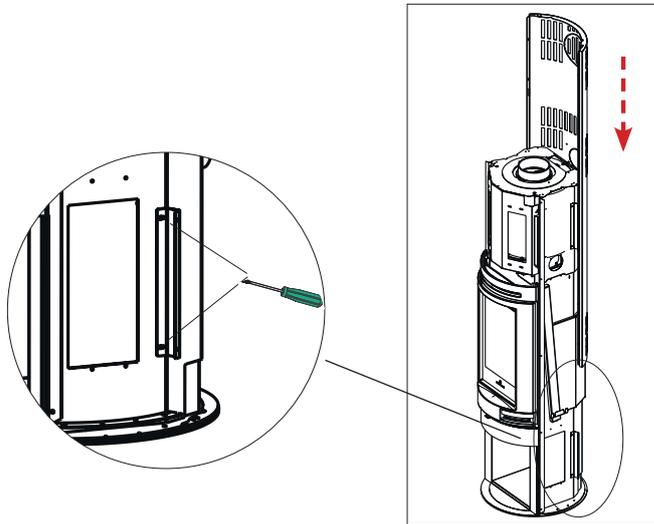
Die Rückwand mit 2 Schrauben oben festschrauben.
