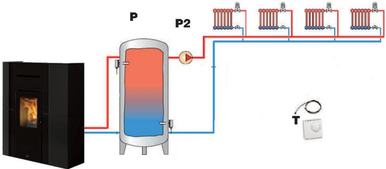
Das Produkt moduliert entsprechend der Wassertemperatur und schaltet sich entsprechend der PUFFER-Temperatur (P) ein / aus.
