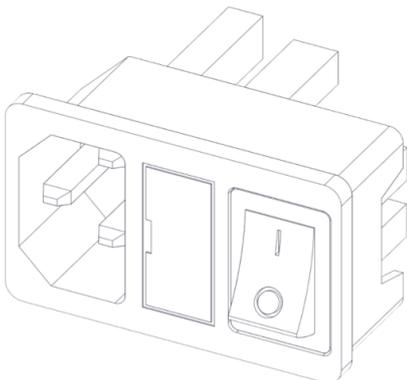
Um das Gerät einzuschalten, drehen Sie den Schalter von 0 auf 1.
