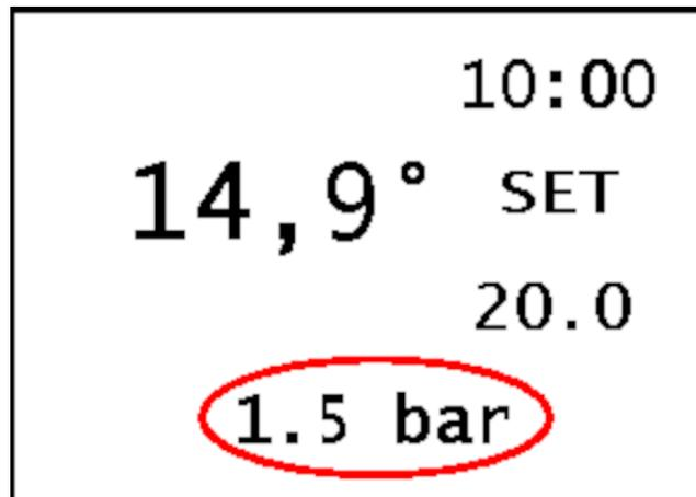
Auf der Anzeige kann der Wasserdruck abgelesen werden. Daher ist kein analoger Druckmesser vorhanden.
