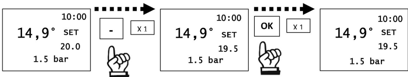
Wenn das Stand-by deaktiviert ist, moduliert das Gerät, um zu versuchen, die EINGESTELLTE Temperatur (im Beispiel 19,5 °C) beizubehalten. Wenn das Stand-by aktiviert ist, schaltet sich das Gerät aus dem gleichen Grund ein/aus.
