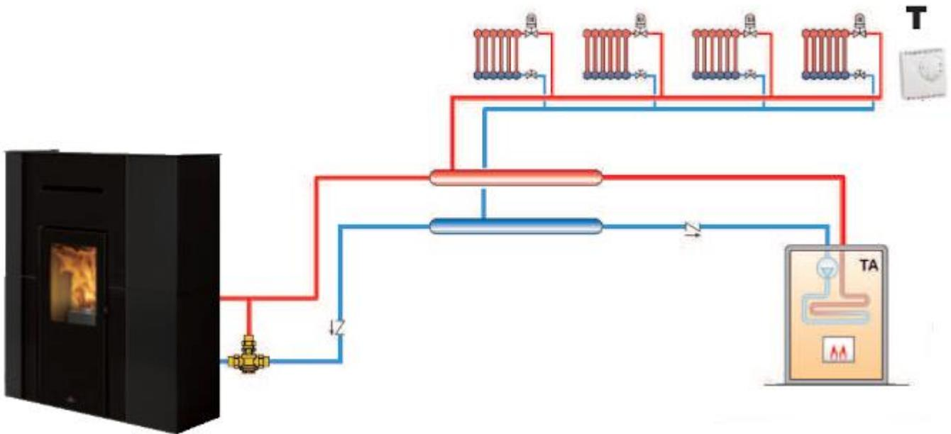
Das Produkt moduliert je nach Wassertemperatur und schaltet sich je nach Umgebungstemperatur (Fühler oder Thermostat T) oder nach Wahl des Installateurs je nach Wassertemperatur ein/aus.
