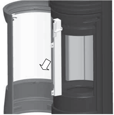
Abb. 5.4 Nur einen seitlichen Luftkanal demontieren
