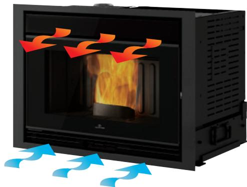
\* Es müssen zwei Lüftungsgitter (Oberfläche größer als 100 cm<sup>2</sup>) vorgesehen werden, ein erstes unter dem Einsatz und ein zweites mindestens 50 cm über dem Einsatz oder anderweitig mit dem Innenfach verbunden, in dem der Einsatz positioniert wird. Diese Gitter verhindern einen Wärmestau im Inneren, der dann zurückgewonnen wird, um den Installationsraum zu heizen
