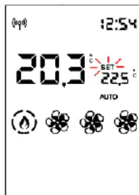
Nach der Einstellung der Installationsraumtemperatur (oder manuell mit der Raumleistung) verlässt man die Einstellung, wenn man 5 Sekunden lang keine Taste drückt. Die Anzeige SET hört auf zu blinken.
