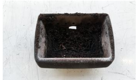
BEISPIEL VERSCHMUTZTE BRENNSCHALE
