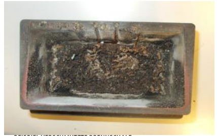
BEISPIEL VERSCHMUTZTE BRENNSCHALE
