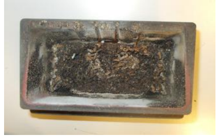
BEISPIEL VERSCHMUTZTE BRENNSCHALE
