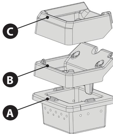
Für die Reinigung muss die Feuerschutzplatte (C), die Rutsche (B) und anschließend die Brennschale (A) erhoben und entfernt werden.
