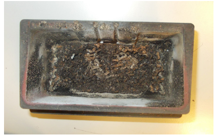
BEISPIEL VERSCHMUTZTE BRENNSCHALE
