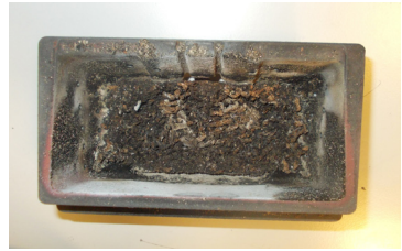
BEISPIEL VERSCHMUTZTE BRENNSCHALE
