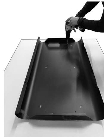
Fig. 50 - Die Oberflächenausführung an der Seitenwand anschrauben
