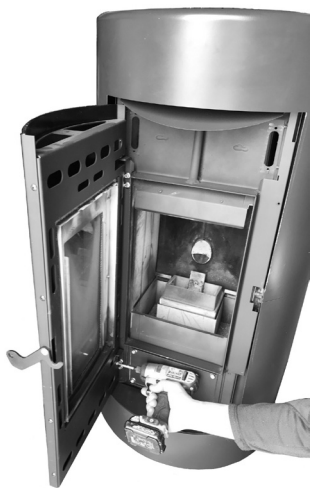
Fig. 63 - Ausbau der Tür
