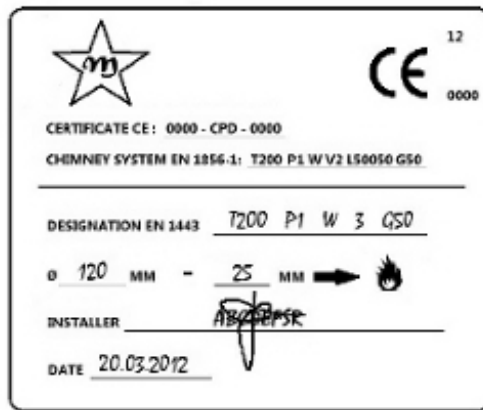
Fig. 4 - Beispiel für Typenschild
