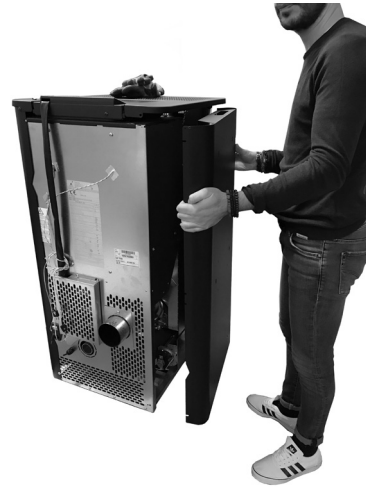
Fig. 48 - Abnehmen der Seitenwand
