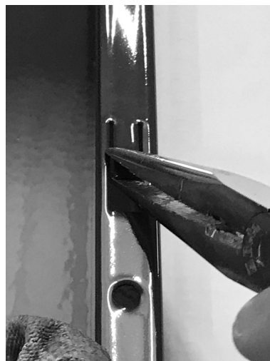
Fig. 45 - Biegen der kleinen Zungen nach außen
