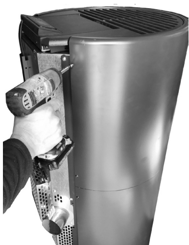
Fig. 66 - Die hinteren Schrauben entfernen.
