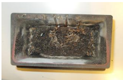
BEISPIEL VERSCHMUTZTE BRENNSCHALE
