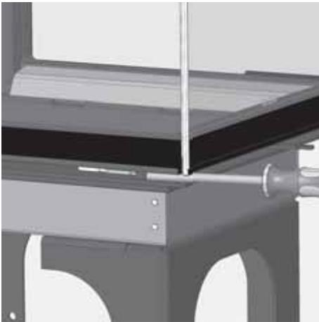
Abb. 3.27 Einsatzstück mit flachem Schraubendreher heraushebeln
