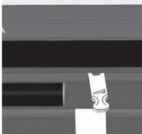
Abb. 3.12 Luftschieber rechts, bis Anschlag
