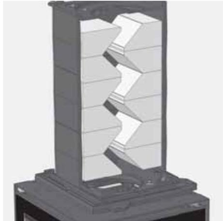
Abb. 3.29 Guss-Speicheraufsatz, Heizgasführung, Schnittdarstellung
