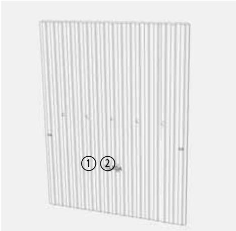
Abb. 4.5 Feuerraumauskleidung KALA QS, KALA PS oder KALA US, Gussteil
