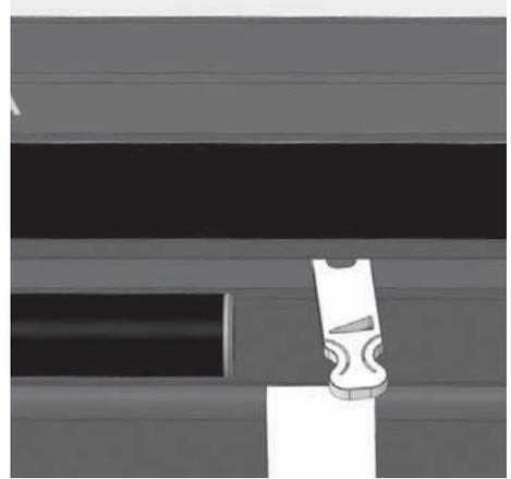
Abb. 3.10 Luftschieber rechts, bis Anschlag
