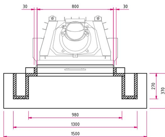
**Hinweis Seitenansicht M 1:25:** AS: Abgasstutzen, VLS: Verbrennungsluftstutzen, OKFF: Oberkante Fertigfußboden
