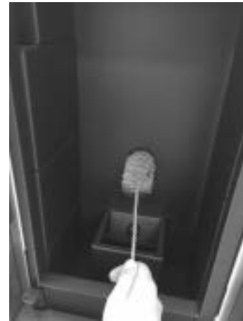
Fig. 36 - Reinigung mit Flaschenbürste
