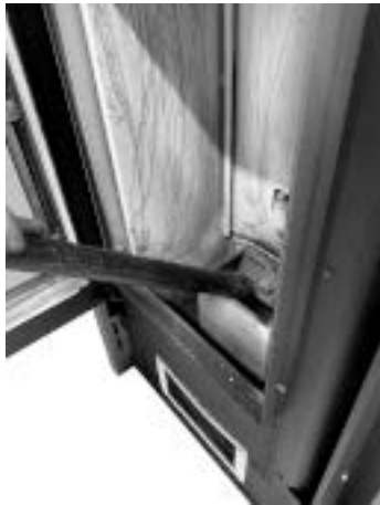
Fig. 35 - Reinigung Fach Brennschale
