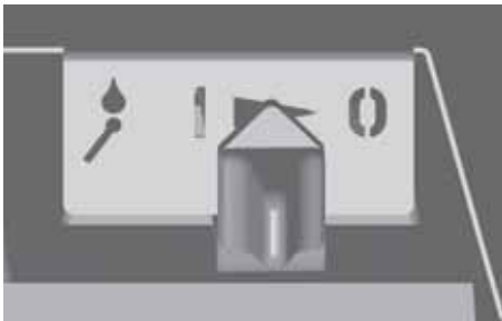
Abb. 4.5 Verbrennungsluftschieber mittig, Regelbereich
