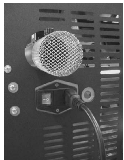
Elektrischer Anschluss des Heizofens
