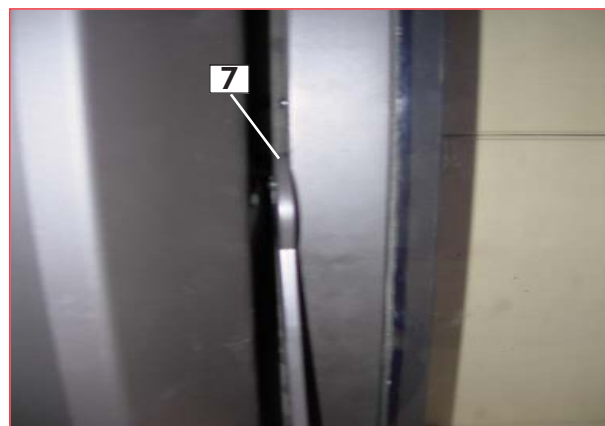
Figura 3 : bloccaggio portellone aperto (ruotare il nottolino di 90°)
