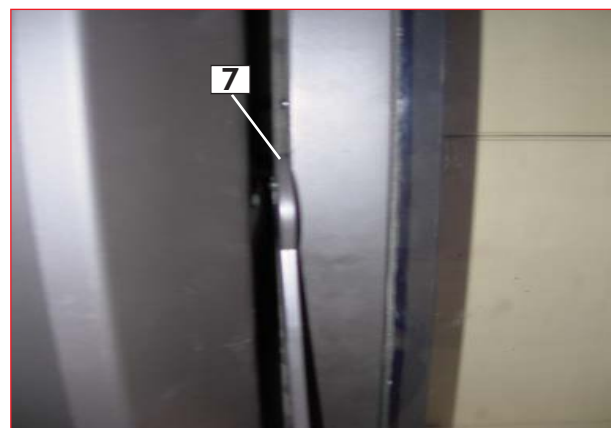
Abbildung 3: Geöffnete Türsperre (die Knagge um 90° drehen)
