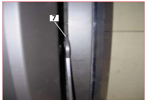
Εικόνα 3: Εμπλοκή ανοιχτής πόρτας (στρέψτε τον εμπλοκέα 90°)
