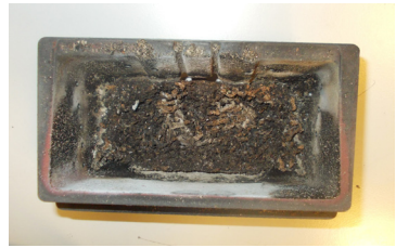
BEISPIEL VERSCHMUTZTE BRENNSCHALE
