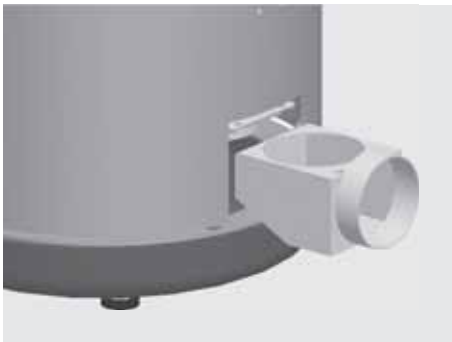
Abb. 3.7 NOVIA C: Anschlusskasten einschieben
