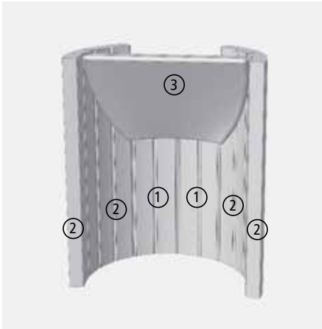
Abb. 5.3 Feuerraumauskleidung NOVIA W
