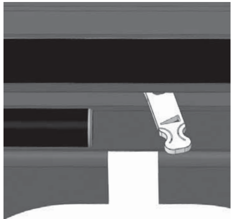
Abb. 3.1 Luftschieber ganz rechts, über den Anschlag hinaus, in Anheizstellung
