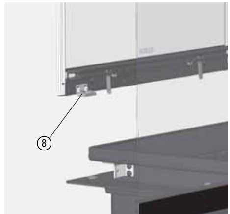
Abb. 3.24 Schalterblech am hochschiebbaren Türsegment montieren bei KALA QS, KALA PS oder KALA US
