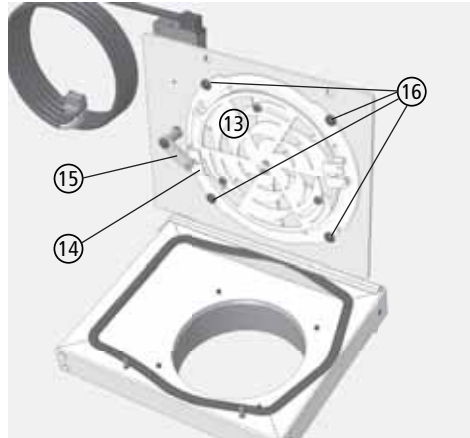
Abb. 3.13 Montieren der Luftventileinheit im Deckel der VSR-Box
