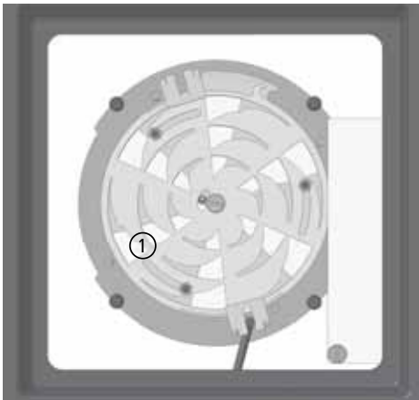
Abb. 3.7 Luftventileinheit im Boden des KALA
