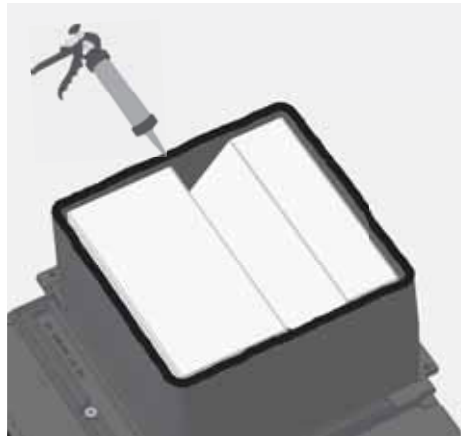
Abb. 2.33 ersten Guss-Ring mit Eisenkitt versorgen
