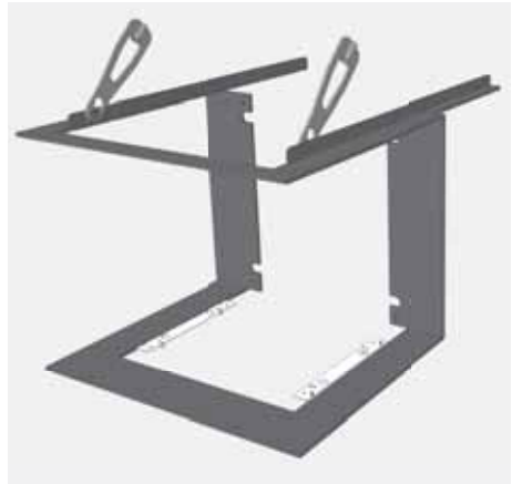
Abb. 2.93 4-teilige Anbaurahmen für US-, PS- oder QS-Geräten
