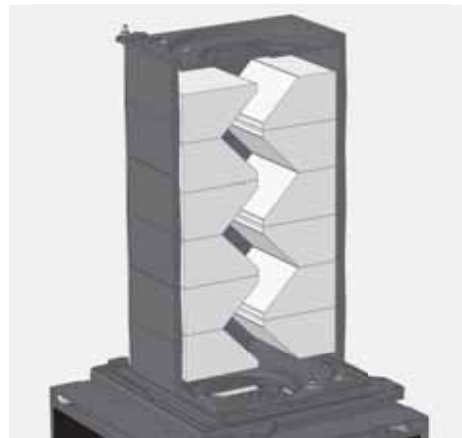
Abb. 2.29 fertige Heizgasführung im Guss-Speicheraufsatz
