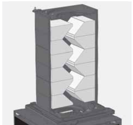
Abb. 2.35 fertige Heizgasführung im Guss-Speicheraufsatz
