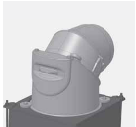
Abb. 2.49 3-teiliger Heizgasstutzen auf dem Guss-Speicheraufsatz
